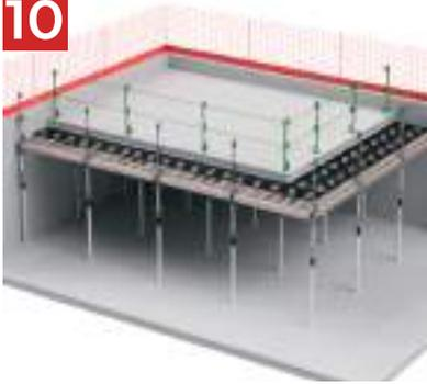
Sécuriser la dalle coulée avant la dépose de la sécurité provisoire ou toute intervention de décoffrage.
