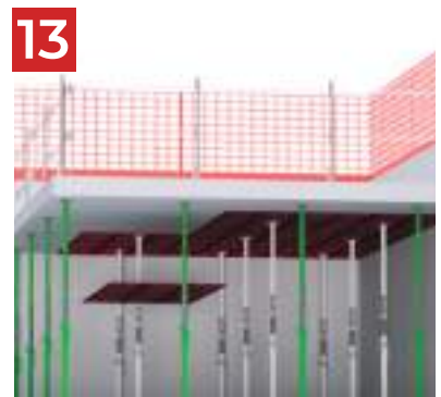
13 Récupérer les étais et les contreplaqués au fur et à mesure et mettre en place des étais de séchage.
