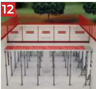
Coffrer l'about de la dalle, ferrailer et couler le béton.
